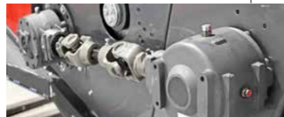
Der Professional-Drive sorgt für mehr Laufruhe und eine optimale Kraftübertragung (Standard bei „Evolution“ & „G3“)
