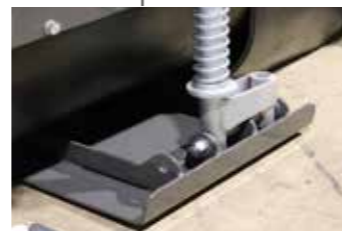
Stoppelnicker schützen die Reifen des Mähdreschers (Option)
